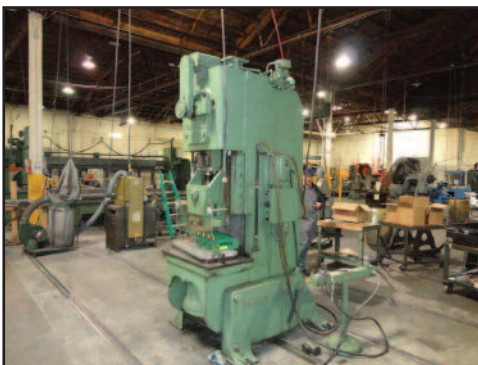
USI Clearing 60 Ton OBI Punch Press
