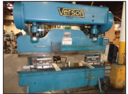
Verson 8'x65 Ton Power Press Brake
