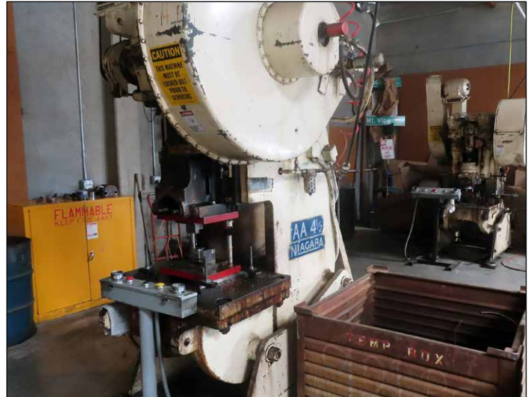
Niagara AA 4-1/2, 75 Ton OBI Punch Press
