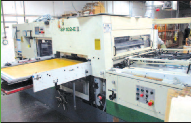
Bobst Mod. SP102-EII, 28" x 40" x 250 Ton x 75000 SPH High Spd. Auto. Die Cutter
