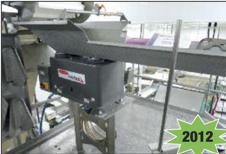
H&C Fast Back 260E-Gw Feeder
